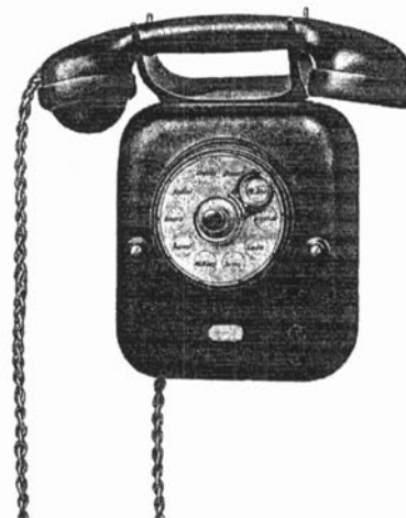
Aparell telefònic selector de paret Siemens & Halske AG (Berlín).
